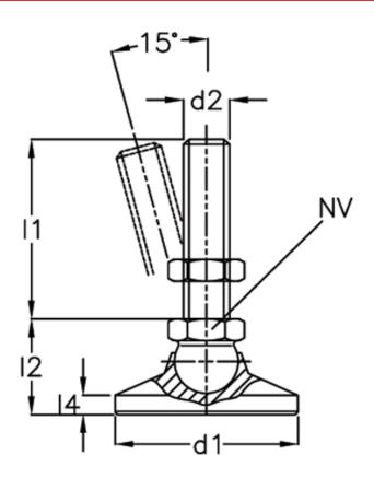
d1 = 60 Static load = 30 d2 = M16 Weight in (g) = 550 l1 = 125 l2 = l3 = 37.5 l4 = l5 = 10
